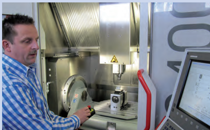
Ton van Rooij aan de slag met de Hermle C 400 basic. Dit is een machine met een machinebereik van 850 mm x 700 mm x 500 mm (X x Y x Z) voorzien van een Heidenhain CNC-besturing. De machine is voorzien van gereedschaps- en werkstukmeting (respectievelijk van Blum en Heidenhain) en een interne koeling tot 40 bar. Ton en Anja van Rooij programmeren samen de vijffasser met het programma EdgeCAM. In de machineklem een werkstuk gemaakt met EdgeCAM (foto's: Reinold Tomberg)
