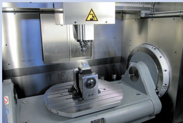
Een kijkje in de Hermle C 400 basic van Rotech. Het is een machine in de bekende bouwwijze van Hermle: een rotatie- en zwenkas in het werkstuk en de drie lineaire machineassen bevinden zich in het gereedschap (gemodificeerde gantry-bouwwijze van Hermle). Op de rondtafel kan een massa van maximaal 600 kg opgespannen worden. Opvallend is de relatief grote ruimte tussen de wangen van de draaizwenktafel van de machine
